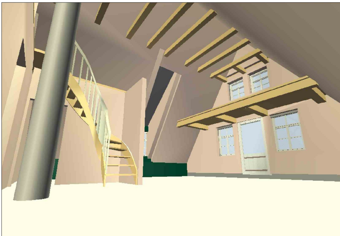
Abb. 8: Computersimulation in der Entwurfsphase: Überprüfung der Raumwirkung bei der Anordnung von statisch notwendigen Kehltriegeln und Hahnenbalken.
