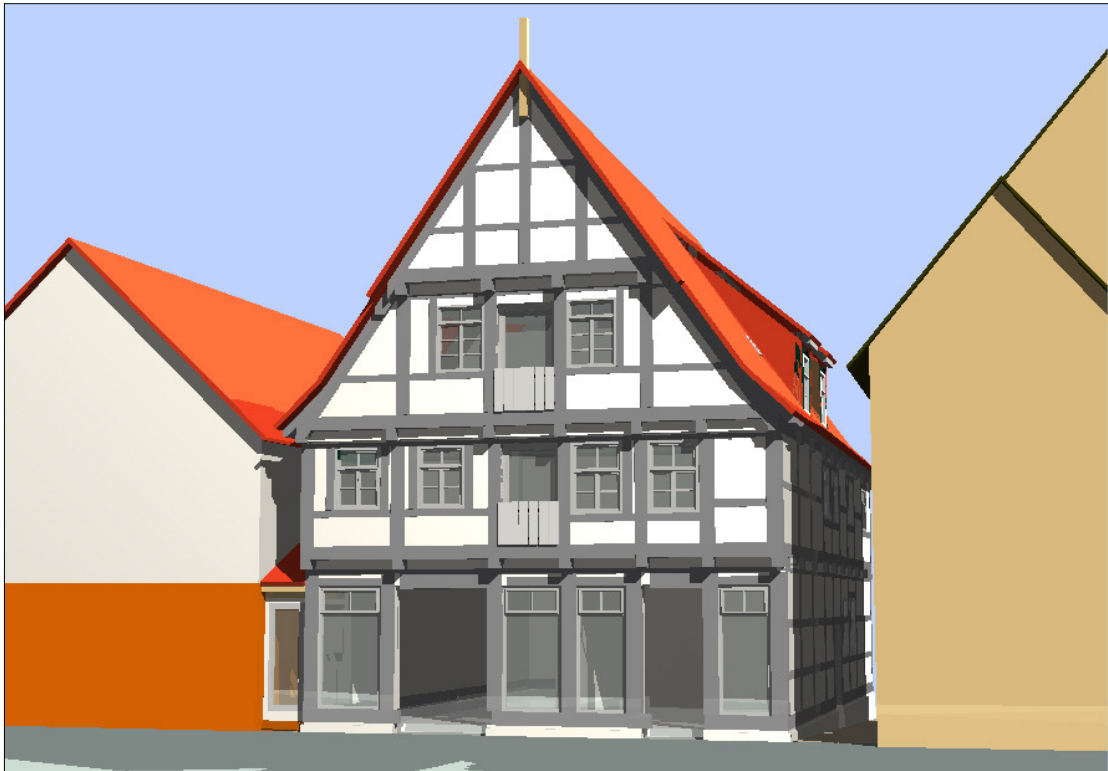
Abb. 7: Sanierungsentwurf mit rekonstruiertem Giebel, Ladeluken, Schlepptreppen und zwei Ladengeschäften im Erdgeschoß.
